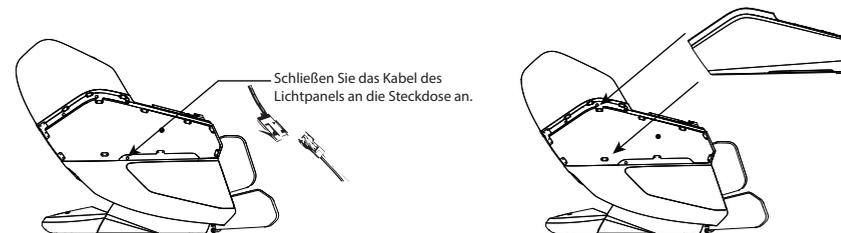
① Schließen Sie das Kabel des Lichtpanels an den Anschluss an.
